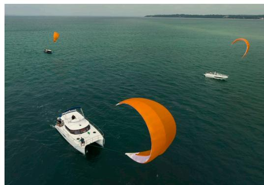
Conçu comme voile de secours, il est devenu une alternative écologique pour la plaisance et la pêche côtière. Silencieux et léger, il permet une navigation fluide de 3 à 6 nœuds.
