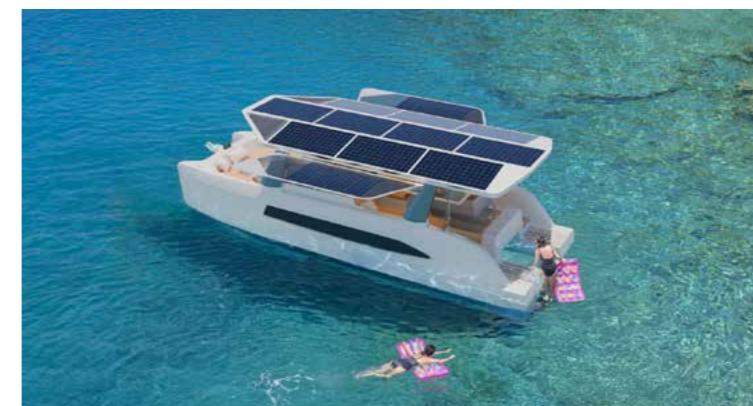
Catamaran 100 % électro-solaire pensé pour la performance et l'autonomie. Grâce à ses 35 kWh d'énergie solaire quotidienne et ses 41 kWh de batteries, il assure une navigation silencieuse et zéro émission, avec tout le confort nécessaire à la vie à bord..
