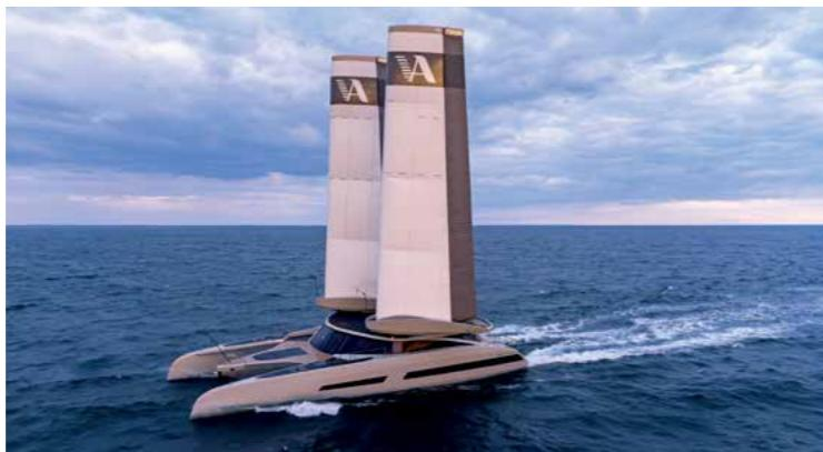
Ce catamaran de 70 pieds réunit le meilleur des énergies renouvelables : propulsion par ailes Aeroforce, moteur électrique, hydrogénération et 70 m<sup>2</sup> de panneaux solaires.
