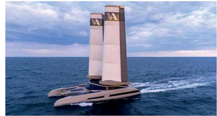
Le MODX 70 représente une avancée majeure dans la voile écoresponsable. Ce catamaran 100% électrique, à propulsion silencieuse et zéro émission, s'appuie sur des matériaux composites recyclables et un système énergétique durable éolien et solaire. Son design contemporain met en valeur des espaces extérieurs généreux, un salon panoramique et des cabines lumineuses, offrant un confort exceptionnel. Véritable pionnier, il illustre la volonté d'imaginer un yachting respectueux de l'environnement.
